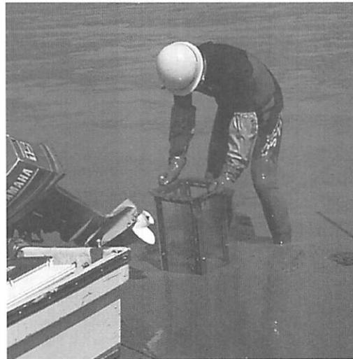
図3-2 ボックス型サンプラーを用いたバルクサンプリング状況
